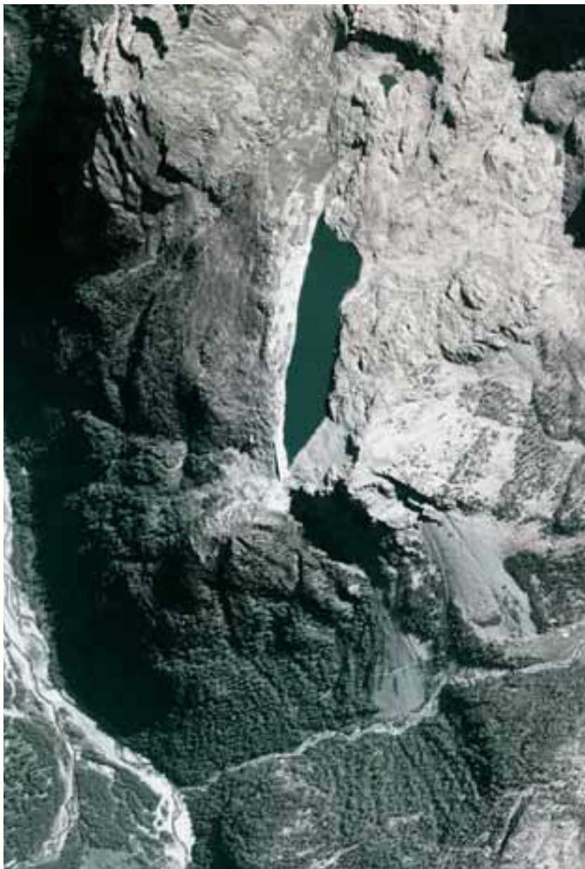
Il Lago Pirola (Valle del Ventina, Valtellina, Lombardia), rialzato artificialmente da uno sbarramento lungo la sponda meridionale, ha il fianco sinistro impostato lungo una evidente frattura
