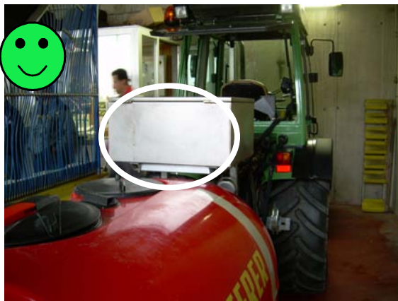
Fig. 7 – Trasporto in sicurezza degli agrofarmaci in campo impiegando appositi alloggiamenti presenti sulla macchina irroratrice.
