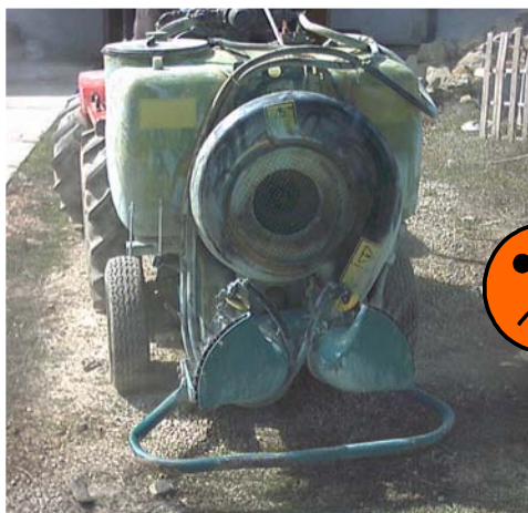
Fig. 83 - Non rimuovere i depositi esterni accumulatisi sull'irroratrice subito dopo aver eseguito il trattamento può comportare un'elevata contaminazione dell'area dove la macchina viene ricoverata, può danneggiare parti dell'attrezzatura e può rappresentare un pericolo per le persone
