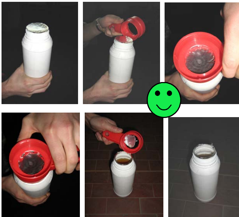
Fig. 63 – Rimozione in sicurezza della linguetta di protezione dei flaconi di fitofarmaci con l'impiego di un apposito taglierino (cutter).
