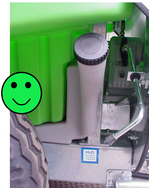
Fig. 42 – Il serbatoio lavaimpianto deve avere almeno il 10% della capacità nominale del serbatoio principale o almeno 10 volte il volume diluibile (EN 12761). La sua presenza consente di effettuare in campo il lavaggio dell'irroratrice e lo smaltimento della miscela residua nel serbatoio principale. Deve essere progettato in modo da consentire il risciacquo delle tubazioni anche con il serbatoio principale pieno e la diluizione del residuo all'interno dello stesso.
