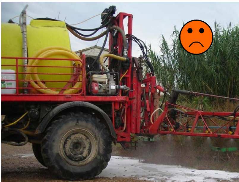
Fig. 74 – Attivare l'erogazione della miscela fitoiatrica quando l'irroratrice è ferma comporta un elevato rischio di inquinamento del suolo e delle acque (foto UPC).
