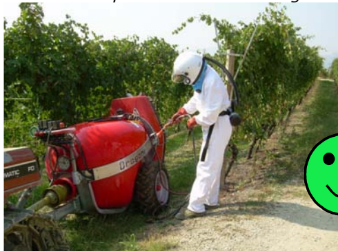
Fig. 85 – Lavaggio esterno della macchina irroratrice in campo al termine del trattamento utilizzando una lancia e l'acqua del serbatoio lavaimpianto.
