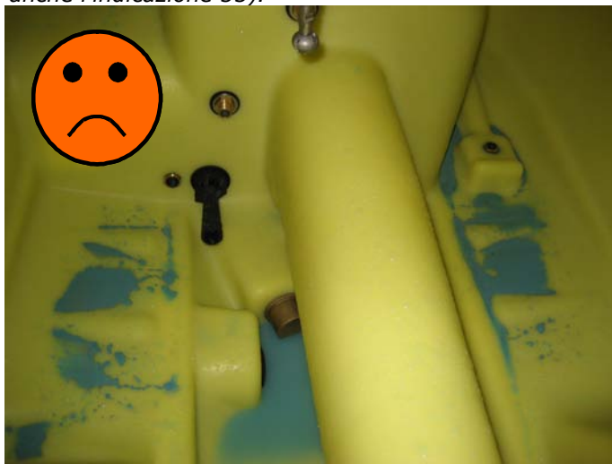
Fig. 39 – Miscela residua nel serbatoio poiché non aspirata dalla pompa (foto E. Nilsson – Visavi)
