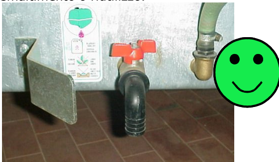
Fig. 45 – Esempio di rubinetto per la raccolta in sicurezza della miscela residua nel serbatoio
