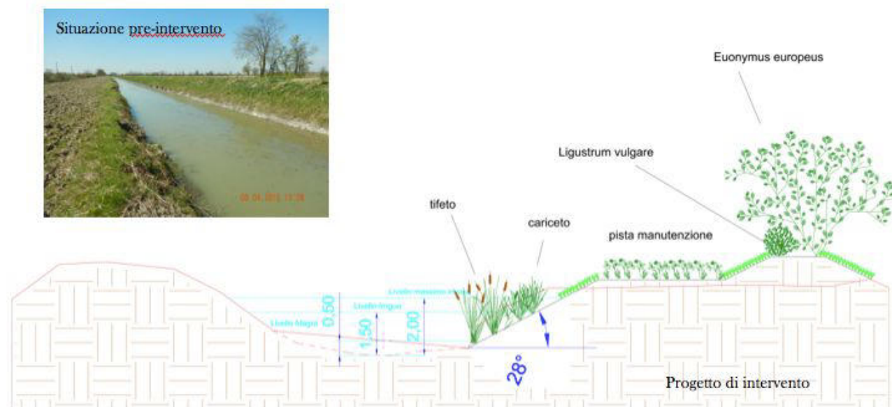
Fig. 11: Progetto di intervento di sistemazione di 2 km del Collettore Alfieri (RE). Immagini tratte dal materiale divulgativo del sito del LIFE RINASCE ( http://ambiente.regione.emilia-romagna.it/life-rinasce ). Si noti l'allargamento della sezione del canale, l'aumento della capacità di invaso, l'addolcimento della pendenza delle sponde e l'inserimento di canneti e vegetazione come elementi naturalistici.
